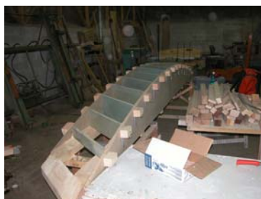
Fabrication des limons courbes sur gabarits en lamellé collé de sapin de pays
