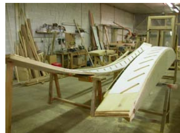
Fabrication des limons courbes sur gabarits en lamellé collé de sapin de pays
