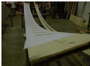
Fabrication des limons courbes sur gabarits en lamellé collé de sapin de pays
